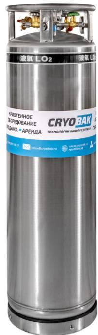
**Криоцилиндр** – газификатор малого объема представляет собой криогенный сосуд, с многослойной экранно-вакуумной изоляцией. Криоцилиндр предназначен для хранения, транспортирования, газификации криогенной жидкости, и выдаче ее потребителю в жидком и газообразном виде при необходимом давлении.
